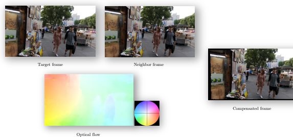
图 53 基于光流的显式运动对齐
